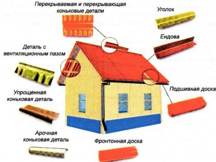
Рисунок 1. Фасонные детали кровли
